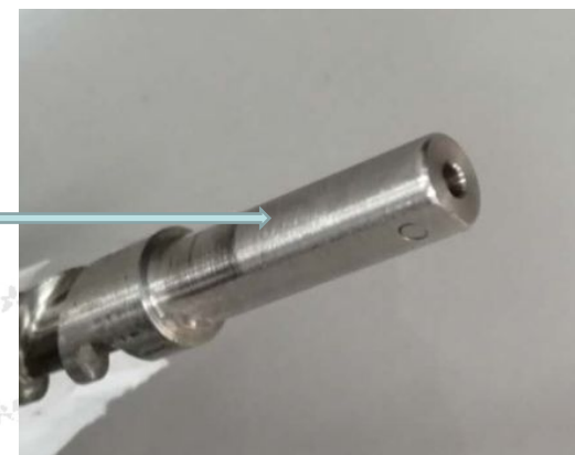
Обратите внимание на твердое направление винта и муфты во время установки, чтобы избежать соскальзывания.
